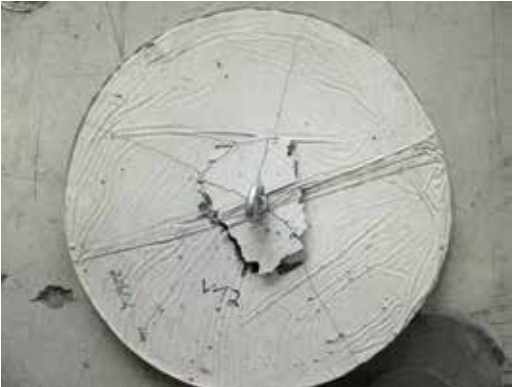
► Auszugversuch aus textilbewehrtem UHPC mit ZÜBLIN-Anker / Pull-out test of textile reinforced UHPC using a ZÜBLIN-anchor
