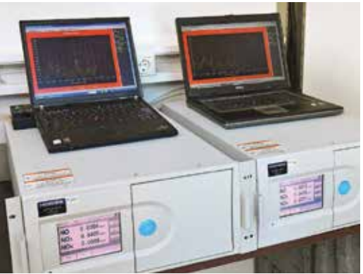
► Messgeräte zur Messung der Stickstoffdioxidkonzentrationen der aktiven und inaktiven Fläche / NO x Analyzers for measuring the concentrations of nitrogen oxides from the active and inactive fields
