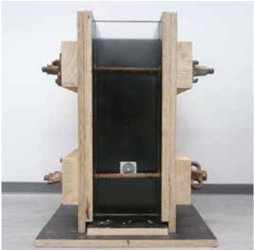
► Versuchsschalungen zur Untersuchung der fleckigen Dunkelverfärbungen (li: Stütze; re: Wand) / Experimental molds for the investigation of spotty dark discolorations (left: column / right: wall)
