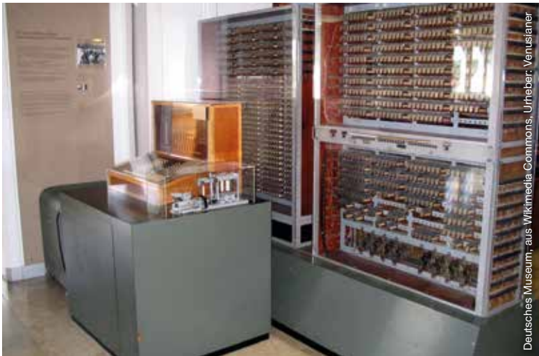
▲ Abb. 1: Die Z3 – der erste funktionsfähige, programmierbare digitale Rechner der Welt, mit Speicher und einer Zentralrecheneinheit (aus Telefonrelais) / Fig. 1: Replica of the Zuse Z3, Deutsches Museum Germany. The first functional, programmable digital computer in history, including memory and a CPU (made of telephone relays)
