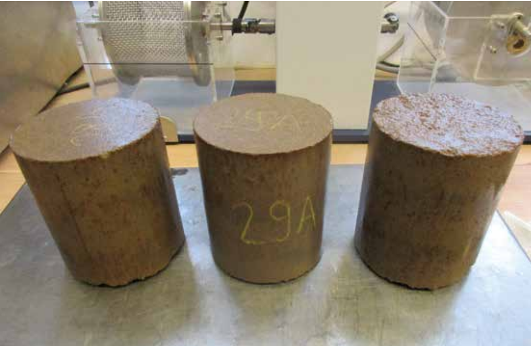
► Probekörper mit Zugabe von Braunkohlenflugasche nach „bestandener“ Unterwasserlagerung / Specimen with addition of lignite fly ash after underwater storage
