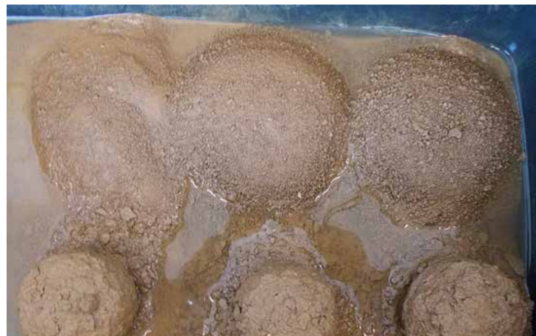
► Unterwasserlagerung der Proben / Underwater storage of the specimen
