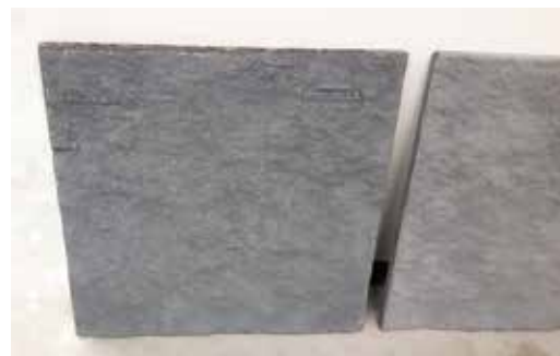
► Musterelemente mit einer Matrizenoberfläche in schwarz / Samples with a die surface in black
