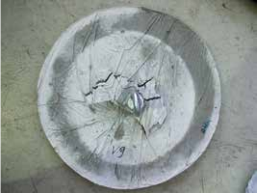
► Auszugversuch aus textilbewehrtem UHPC mit Halfen-Anker / Pull-out test of textile reinforced UHPC using a Halfen-anchor
